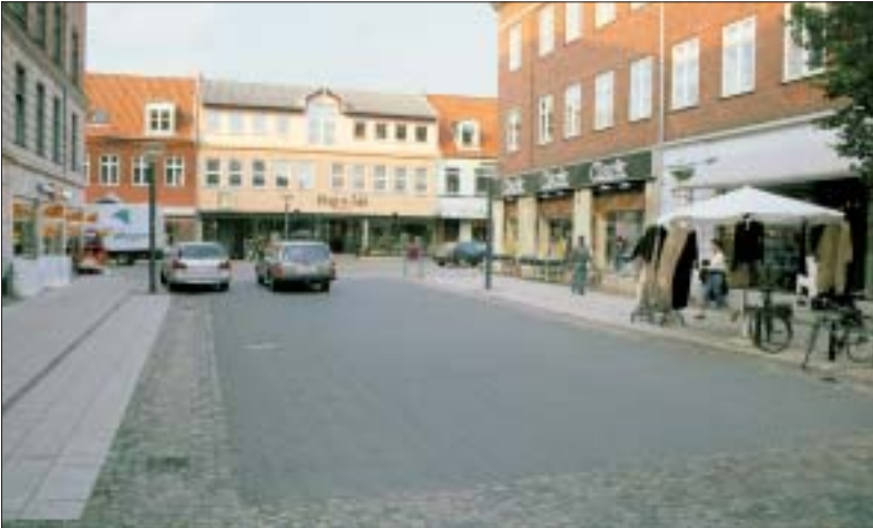
Figur 2.3. Med kørebane og fortov i samme niveau har man med et bånd af chaussésten som markering skabt en mellemting mellem at adskille og blande biler, cykler og gående i denne bymidte. (Ringsted).
