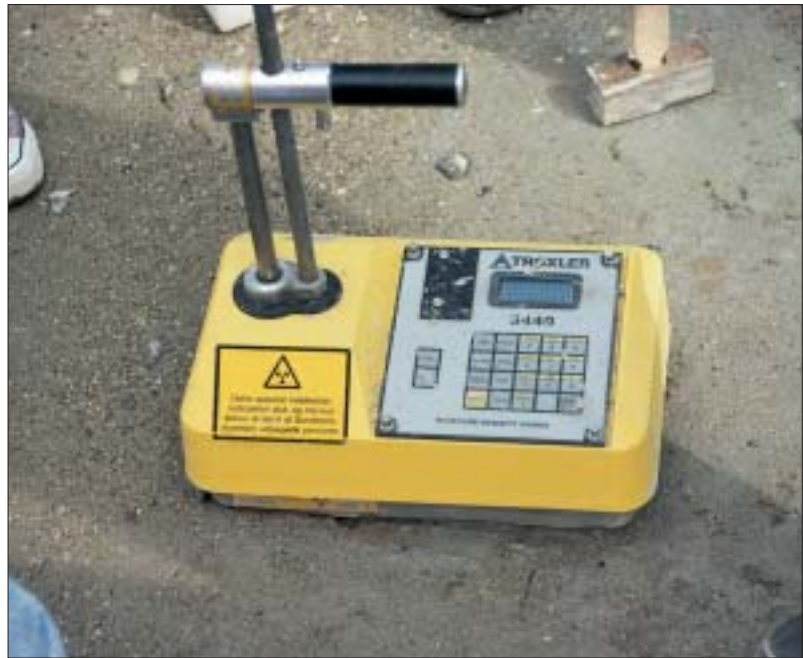
Figur 3.13. De forskellige lags komprimering kontrolleres oftest med en isotop-sonde. „Spydet“ føres ned i jorden og jordens vandindhold og vådrumvægt bestemmes, og holdes op mod værdierne fundet i laboratoriet. (Foto: Torben Dam)
