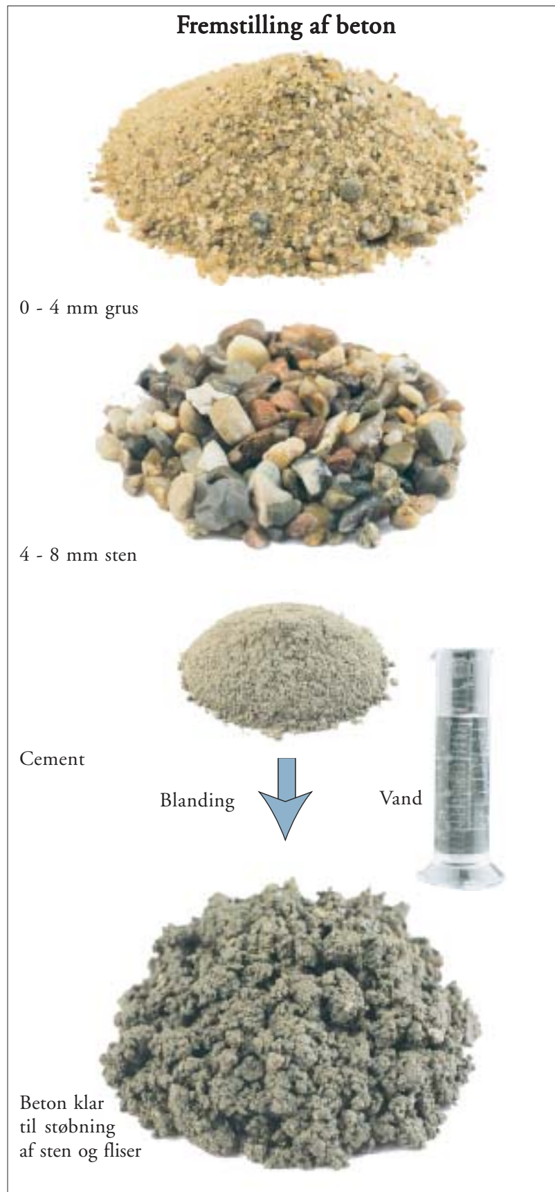
Figur 2.36. Betonbelægninger fremstilles af sand, sten, cement og vand. Disse bestanddele blandes til beton, som støbes og vibreres i forme, til betonsten eller fliser. Se desuden afsnit „2.9 Fremstilling af betonsten og fliser“.
