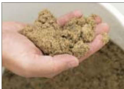
Figur 3.34. Fugemateriale (0-4 mm bakkemateriale) i henhold til „Normer og vejledning for anlægsgartnerarbejde“.
