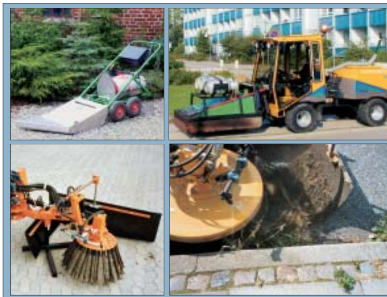
Figur 4.14. Øverst ses to udgaver af ukrudtsbrænderen, og nederst en stålbørste. Overdreven brug af stålbørsten frarådes, da den slider meget på belægningen.
