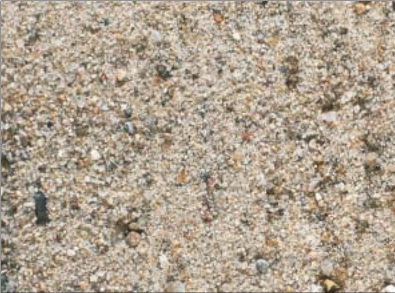
Figur 2.32. Foto af grus forstørret 2 gange. For at få en tæt, stærk fuger er det vigtigt at gruset har en jævn kornfordeling i området 0-4 mm, at fugematerialet komprimeres af trafikken, og at de mindste hulrum fyldes op med diverse forvittringsprodukter
