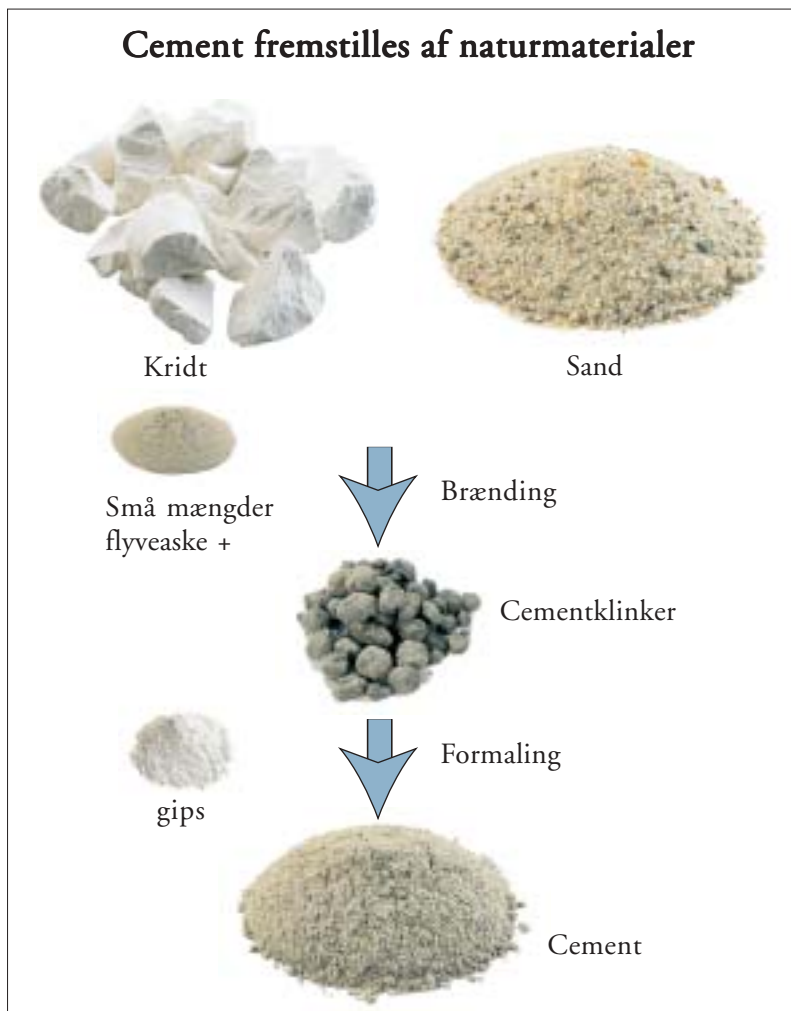
Figur 2.35. Cement fremstilles af sand og kridt samt få procent gips og flyveaske.
