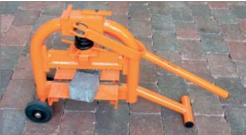
Figur 3.30. Betonsten og fliser kan enten skæres eller klippes når de skal tilpasses.
