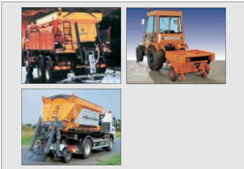
Figur 4.19. Salt kan principielt spredes på tre måder, som tørt salt, fugtet salt eller saltopløsning. Øverst til højre ses en mindre valespredere (tørt salt), øverst til venstre en kombispredere der kan spredde fugtet salt og saltopløsning, og nederst en traditionel tallerkenspredere til tørt salt og fugtet salt.
