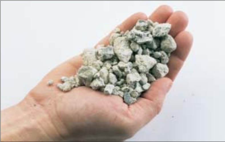
Figur 2.41. Udtjent beton knuses let ved hjælp af knuseanlæg og sorteres i ønskede kornstørrelser. Knust beton kan anvendes i ny beton eller til opbygning af bærelag.
